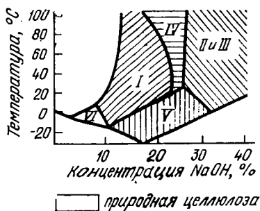
Рис. 35. Зависимость состояния целлюлозы от концентрации NaOH и температуры (по Собуэ, Киссигу и Гессу)
