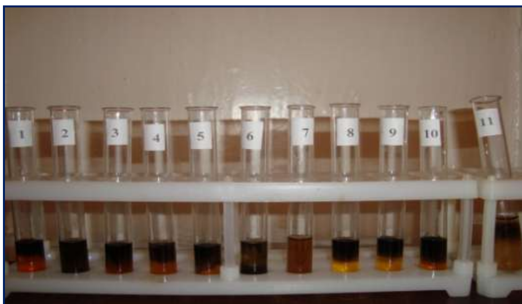
Рисунок 11 – Результаты качественного определения дубильных веществ в пиролизатах растений и готовом препарате: 1 – Донник лекарственный; 2 – Зверобой продырявленный; 3 – Клевер луговой; 4 – Крапива двудомная; 5 – Тысячелистник обыкновенный; 6 – Хвощ полевой; 7 – Чистотел большой; 8 – Вяз узколистный; 9 – Ива козья; 10 – Клен платановидный; 11 – Нормотрофин
