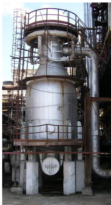
Рис.6.7. Шахтный конвертор метана:
