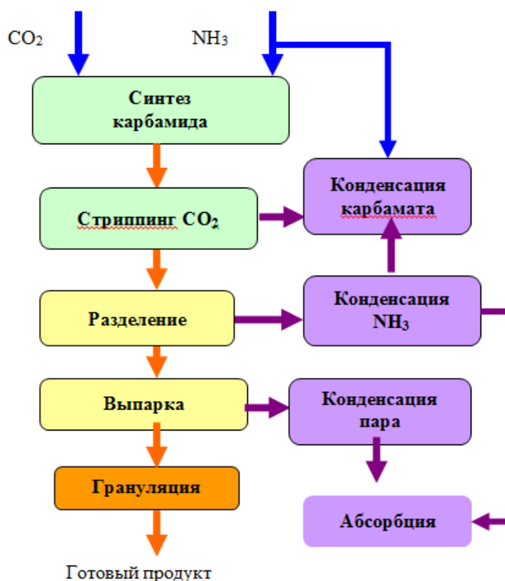
Рис.6.17. Стриппинг-процесс в токе \text{NH}_3 компании Snamprogetti
