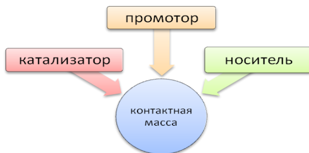
Рис. 3.21. Состав контактной массы
