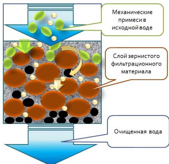
Рис.4.12. Фильтр в режиме фильтрации
