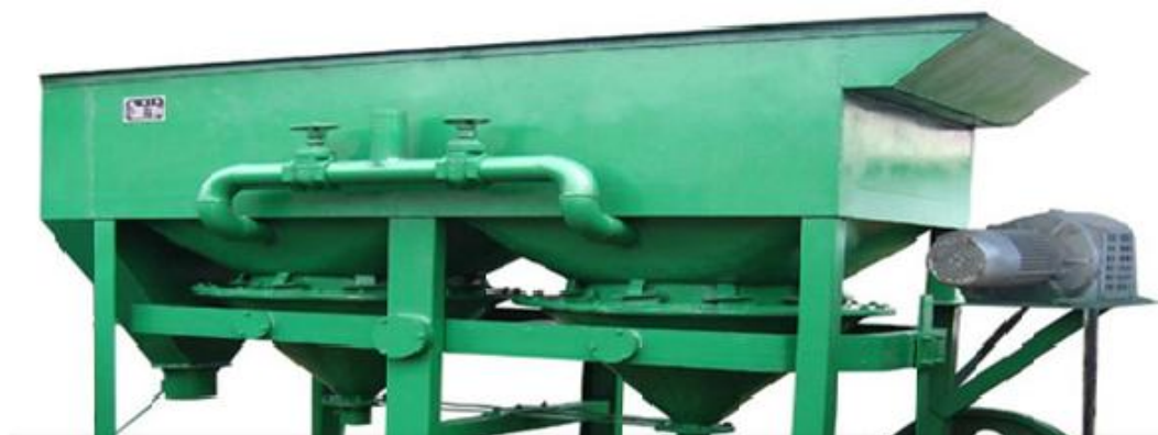
Рис. 2.9. Машина для гравитационного обогащения полезных ископаемых
