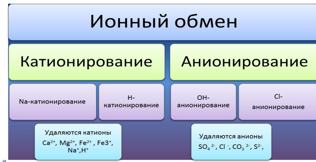
Рис.4.17. Виды ионного обмена
