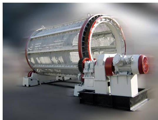
Рис. 2.7. Грохот цилиндрический вращающийся
