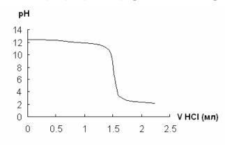
Рис.3.3. Типичная кривая потенциометрического титрования реакционной смеси  $[Ba(OH)_2 + \Gamma B]$
