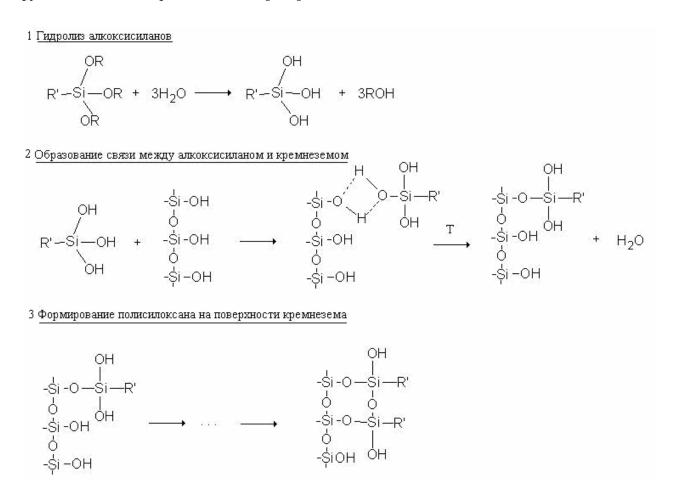
Рис.1.14. Схема модификации поверхности кремнеземов с помощью функциональных органосиланов в водной среде: 1- гидролиз алкоксисиланов; 2 — образование связи между алкоксисиланом и кремнеземом; 3 — формирование полисилоксана на поверхности кремнезема
