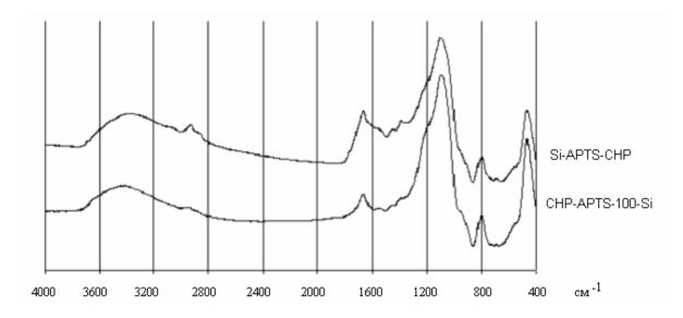
Рис.2.34. ИК-спектры препаратов CHP-APTS-100-Si и Si-APTS-CHP
