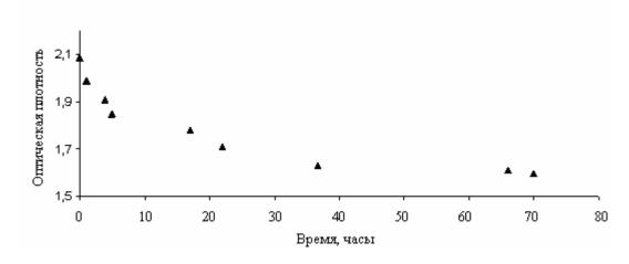
Рис.2.31. Зависимость оптической плотности водного раствора CHP-APTS-100 в присутствии силикагеля от времени (λ=254 нм)
