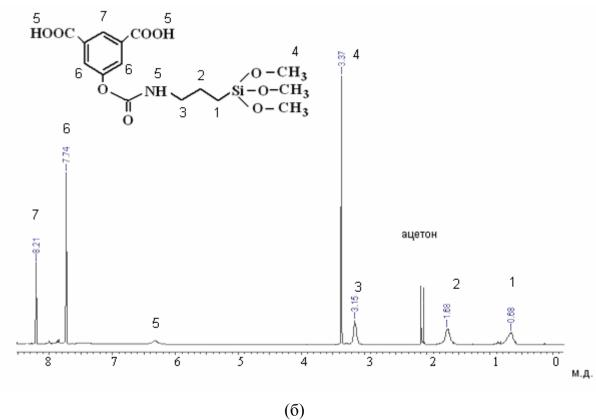
Рис.2.9.  $^{1}$ Н ЯМР спектры: (а) — ванилиновой кислоты, модифицированной с помощью APTS (1b); (б) — 5-гидрокси-изофталевой кислоты, модифицированной с помощью IPTMS (1c)
