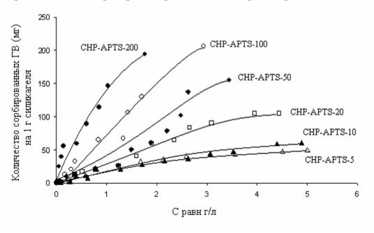
Рис.2.33. Изотермы сорбции APTS-модифицированных препаратов с разной степенью модификации на силикагеле из водного раствора
