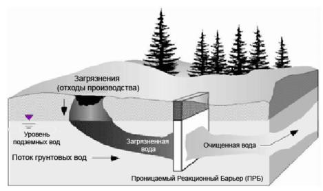
Рис. 1.6. Схема проницаемого реакционного барьера
