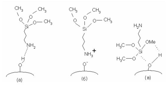
Рис.1.8. Различные этапы взаимодействия APTS с силикагелем. (а) образование водородных связей; (б) перенос протона; (в) конденсация [57]
