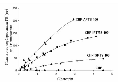
Рис.2.32. Изотермы сорбции препаратов CHP, CHP-APTS-100, CHP-GPTS-100 и CHP-IPTMS-100 на силикагеле из водного раствора
