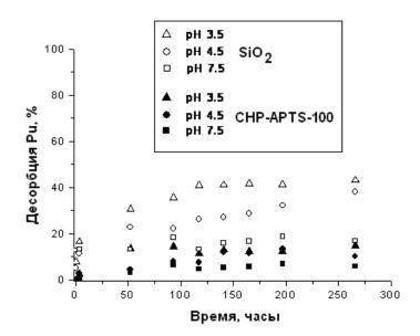
Рис. 2.38. Кинетика десорбции Pu (V) раствором CHP с препарата CHP-APTS- 100-Si (черные значки) и SiO<sub>2</sub> (белые значки); анаэробные условия,
