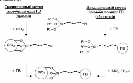
Рис. 2.11. Схемы иммобилизации ГВ на силикагеле с использованием традиционного метода (прямой метод) и предложенного в данной работе (обратный метод)
