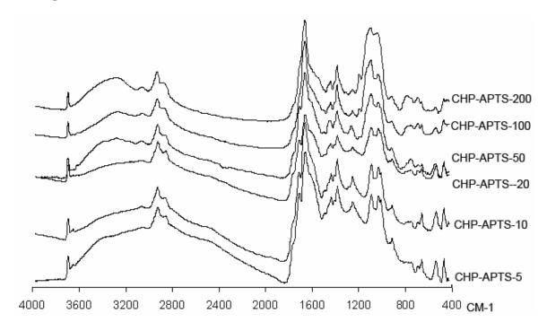
Рис. 2.19. ИК-спектры APTS-модифицированных ГВ с разной степенью модификации
