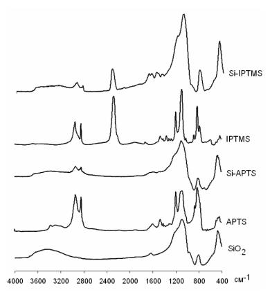
Рис.2.5. ИК-спектры исходного силикагеля, использованных для модификации органосиланов и модифицированных силикагелей
