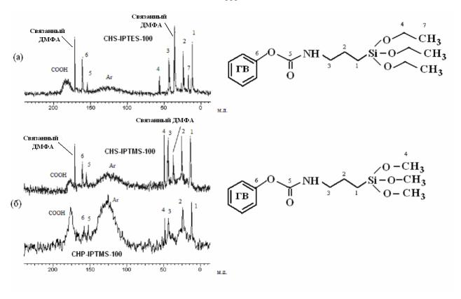
Рис.2.26. <sup>13</sup>С ЯМР спектры: (а) – препарата CHS-IPTES-100 (ДМФА); (б) - CHS-IPTMS-100 (ДМФА) и CHP-IPTMS-100 (ацетонитрил)
