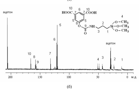
Рис.2.8.  $^{13}$ С ЯМР спектры: (а) — ванилиновой кислоты, модифицированной с помощью APTS (1b); (б) — 5-гидрокси-изофталевой кислоты, модифицированной с помощью IPTMS (1c)
