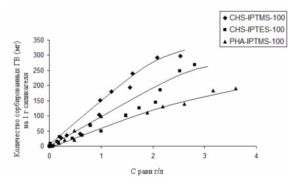
Рис.2. Изотермы сорбции на силикагеле ГВ, модифицированных с помощью изоцианатосиланов в ДМФА
