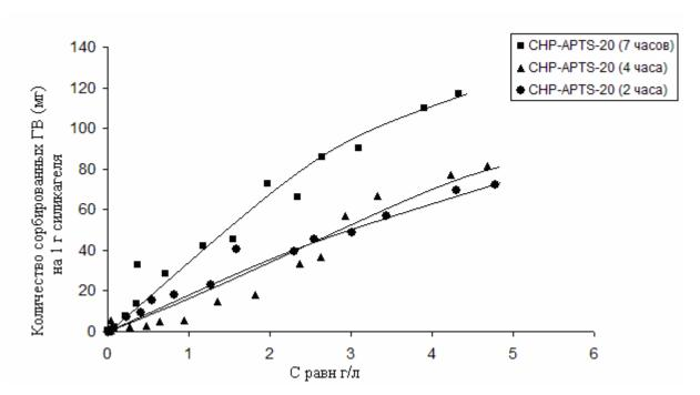
Рис.4. Изотермы сорбции на силикагеле препаратов CHP-APTS-20, полученных в течение 2, 4 и 7 часов
