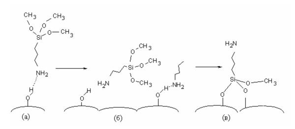
Рис.1.9. Механизм переворота APTS при нагревании: (а) сорбция; (б) переворот молекулы, сопровождающийся конденсацией; (в) конечная структура [192]
