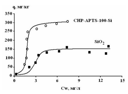
Рис.2.35. Изотермы сорбции ЛПС на исходном силикагеле и иммобилизованных на силикагеле ГВ
