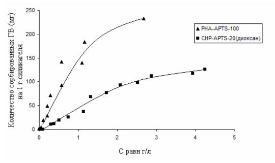
Рис.1. Изотермы сорбции на силикагеле препаратов CHP-APTS-20(диоксан) и PHA-APTS-100
