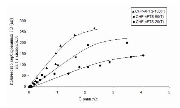
Рис. 3. Изотермы сорбции на силикагеле прокаленных APTS-модифицированных препаратов ГВ
