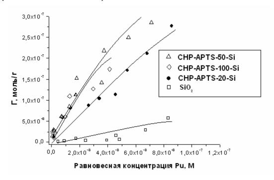
Рис.2.37. Изотерма адсорбции Pu(V) для силикагеля и  $\Gamma B$ , иммобилизованных на силикагеле; аэробные условия,  $C(SiO_2) = 0.35 \text{ г/л}$ ,  $C(CHA-APTS-SiO_2) = 0.35 \text{ г/л}$ , pH 7.5
