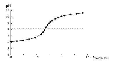
Рис. 3.2. Типичная кривая титрования уксусной кислоты для Са-ацетатного метода
