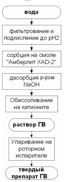
Рис.3.1. Схема выделения препарата ГВ из речной воды
