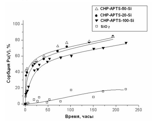
Рис.2.36. Кинетика сорбции Pu(V) на силикагеле и гуминовых производных, аэробные условия, pH 7,5;  $C(Pu) = 1,14\cdot 10^{-8}$  M,  $C(SiO_2) = 0,35 \ \Gamma/\pi, \ C(CHA-APTS-Si) = 0,35 \ \Gamma/\pi$
